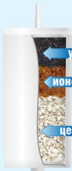
**Умягчающий.** Очищает воду аналогично угольно-цеолитовому картриджу. Дополнительно к этому, благодаря добавлению ионообменной смолы, эффективно уменьшает жесткость воды, в результате этого вода после фильтра становится мягкой, хорошо мылится, уменьшается образование твердого налета в нагревательных приборах и уменьшается риск образования камней в почках и желчном пузыре человека.
