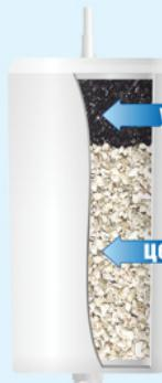
**Угольно-цеолитовый.** Является базовым картриджем. Входит в комплект поставки фильтра. Обладает широким спектром действия и поэтому может использоваться в большинстве случаев. Удаляет из воды тяжелые металлы (железо, марганец и др.), соли жесткости, радионуклиды. Эффективен в отношении органических соединений, например, фенола, бензапирена, аммонийного азота и др. Устраняет хлор, нефтепродукты. Введенное в состав угля серебро подавляет жизнедеятельность микроорганизмов.
