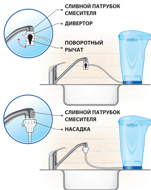
Рис. 4.17. Варианты подключения фильтра.
