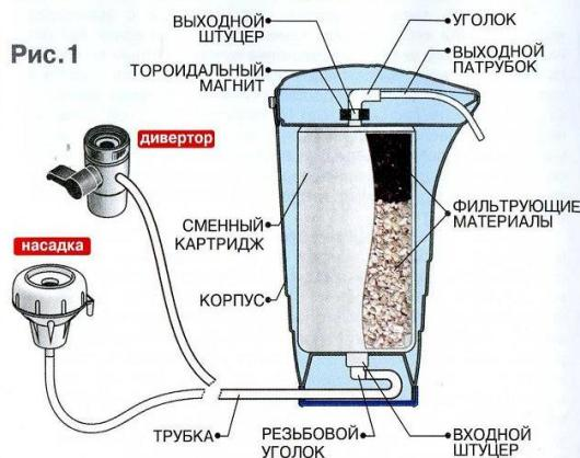
Фильтр (рис.1) состоит из корпуса, внутри которого размещается сменный картридж, заполненный фильтрующими материалами. На выходной штуцер картриджа надет торOIDАЛЬНЫЙ магнит и уголок с выходным патрубком. В нижней части фильтра находится гибкая трубка, один конец которой присоединён с помощью резьбового угла к входному штуцеру картриджа, а другой – к дивертору или к съемной насадке (в зависимости от способа подключения к смесителю).
